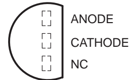
LM285-2.5, LM385-2.5, LM385B-2.5 . . . LP PACKAGE (TOP VIEW)
